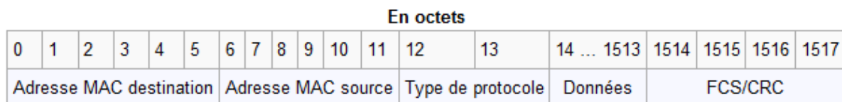
Figure 3 : Structure d'une trame Ethernet
